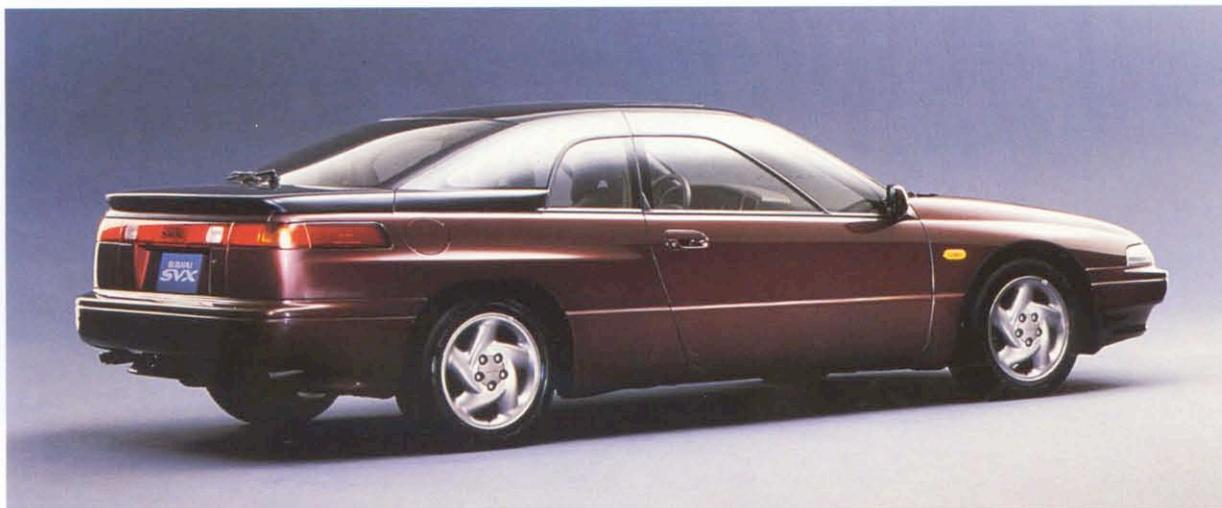
Nella vista posteriore, la SVX presenta un cofano bagagli orizzontale, realizzato in resina come il tetto della vettura.
